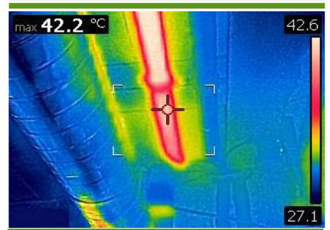
Figura 10: Pérdidas energéticas en conducciones de aire.
