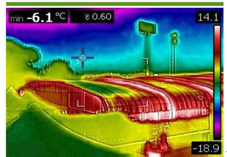
Figura 12: Capa térmica que atrapa energía en el vaso de piscina y reduce en un 80% las pérdidas de energía en el agua y en un 60% en cerramientos.
