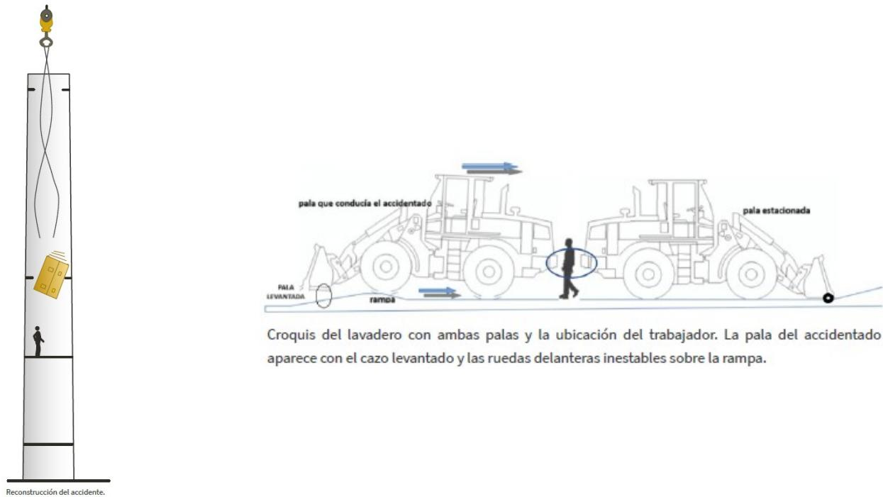
Croquis del lavadero con ambas palas y la ubicación del trabajador. La pala del accidentado aparece con el cazo levantado y las ruedas delanteras inestables sobre la rampa.
