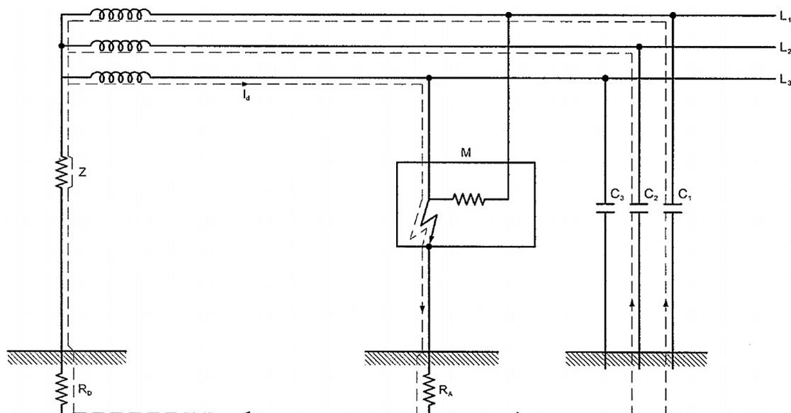
En el esquema IT, se utilizan los dispositivos de protección siguientes:
