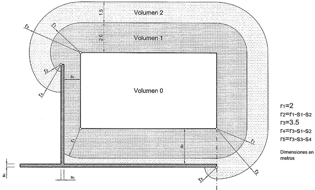
Figura 4. Volúmenes de protección en piscinas con paredes
