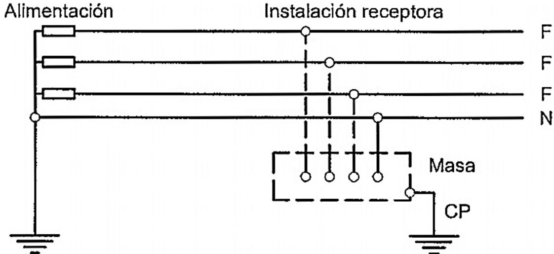
En este esquema las intensidades de defecto fase-masa o fase-tierra pueden tener valores inferiores a los de cortocircuito, pero pueden ser suficientes para provocar la aparición de tensiones peligrosas.
