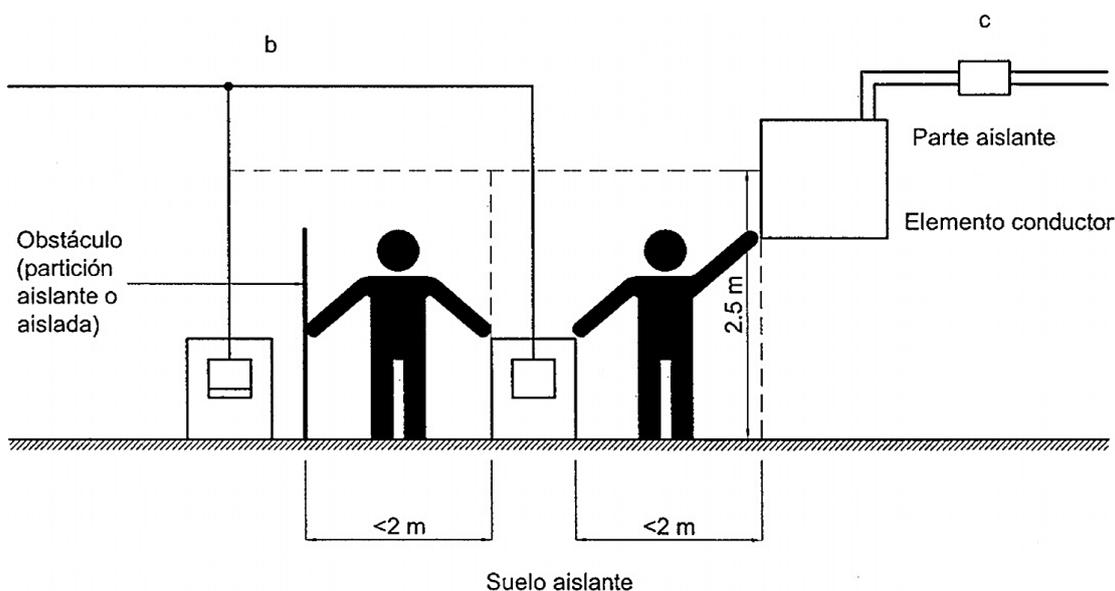
Las paredes y suelos aislantes deben presentar una resistencia no inferior a:
